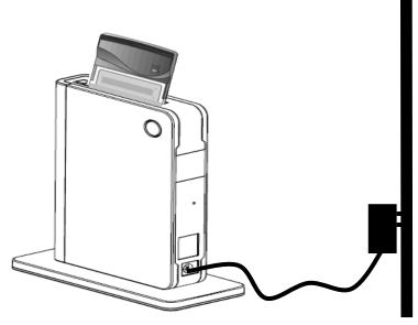
Ao conectar a fonte ao conector do roteador, o LED de força se acenderá indicando que ele esta ligado.
